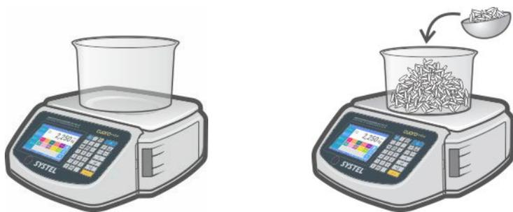
La función TARA se activará solo cuando el peso se encuentre estable sobre el plato. Para eliminar la TARA, descargue el plato y presione nuevamente la tecla TARA.
