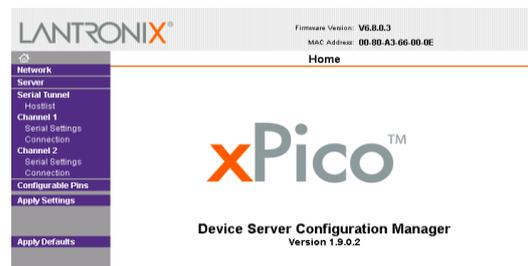
5. En la solapa **Network**, debemos configurar el número de IP fijo que le deseamos asignar a la balanza y la máscara de red. Para este ejemplo le asignamos 192.168.0.10 y la máscara de subred 255.255.255.0. Presione en el boton OK.
